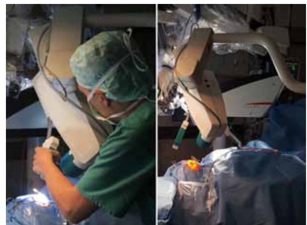
Bild 3: Mikroskopischer Aufbau zur intraoperativen multispektralen Aufnahme (Quelle: Fraunhofer HHI).
